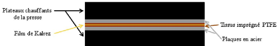
*Figure 8 : Dispositif utilisé lors de la réticulation dans la presse hydraulique.*
