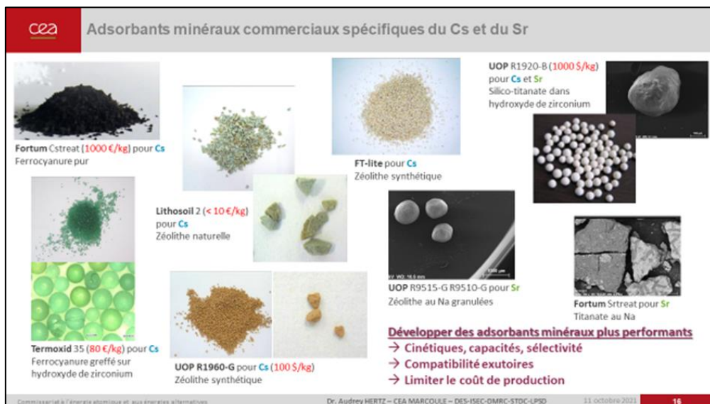
Figure 10 : Principaux échangeurs ioniques commerciaux, pour la sorption du Cs^+ et du Sr^{2+} [107]
