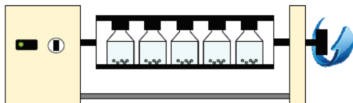
Figure 59. Représentation schématique des essais de sorption en mode "batch"
