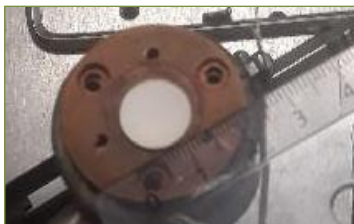
Figure 126. Pastille de brushite pour l'irradiation
