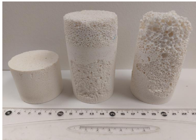
Figure 154. Mise en forme de mousses à base de ciment brushitique et à porosité contrôlée pour la décontamination d'effluents radioactifs
